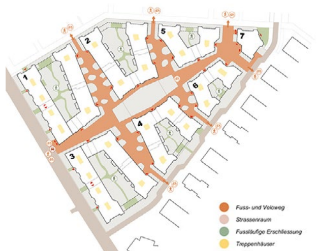
Schema: Erschliessung innerer Dreispitz
