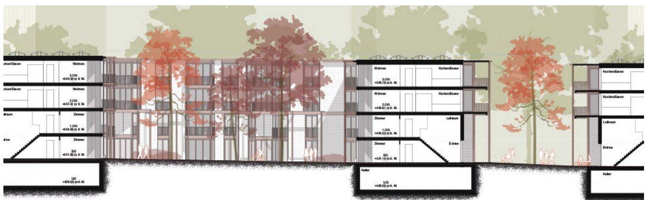
Querschnitt Saatlenpark in Richtung Dreispitzstrasse 1:200 (verkleinerte Darstellung)
