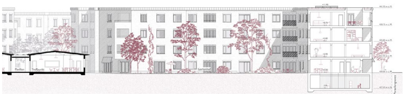
Querschnitt Saatenpark in Richtung Dreispitzstrasse (Wohngasse) 1:200 (verkleinerte Darstellung)
