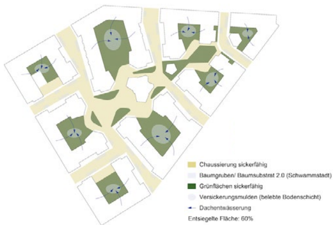
Schema: Regenwassermanagement und Versickerung
