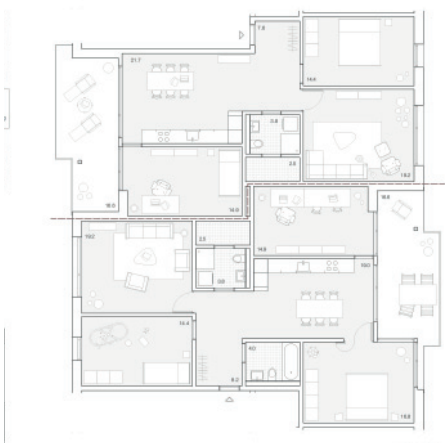
Baufelder 1 und 2 Haus 3 und 4, Wohnungsgrundrisse 1:100 (verkleinerte Darstellung)
