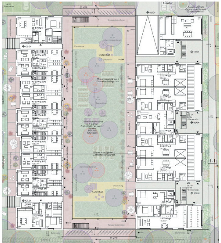
Zeilen-Typ, Geschosswohnungen Haus 1 / 5/7 (links), Haus 3 (rechts), 1:200 (verkleinerte Darstellung)
