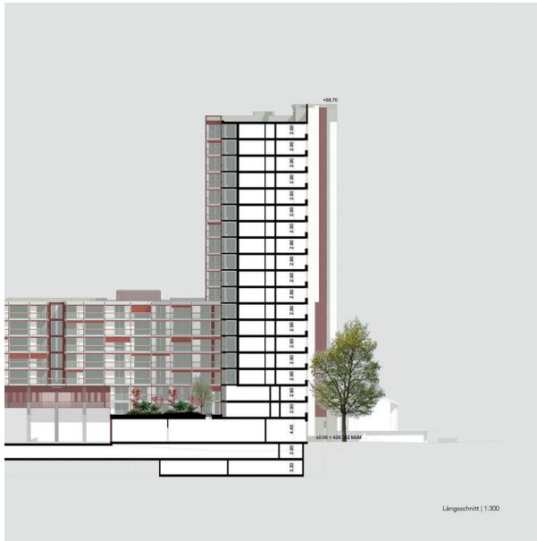
Baubereich A1, Längsschnitt Hochhaus
