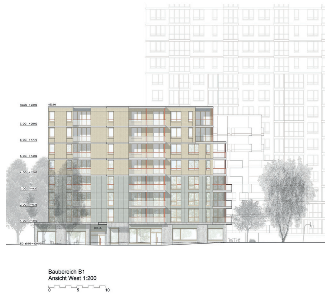
Baubereich B1, Ansicht 1:200, Ansicht West (verkleinerte Darstellung)
