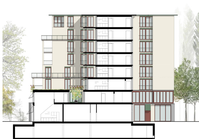
Baubereich B1, Querschnitt Längsbau (verkleinerte Darstellung)
